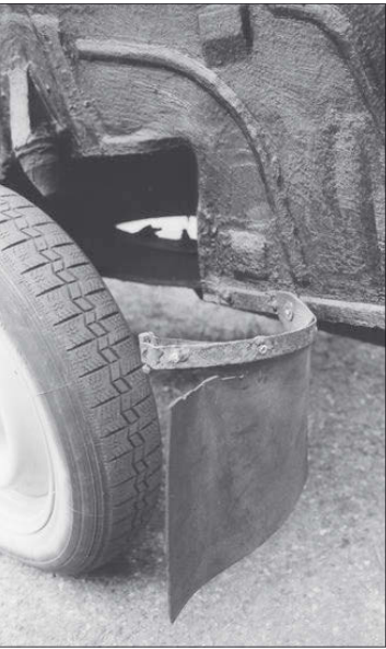
Bij Eenden en Dyanes t/m 1969 was een metalen beugel aan de carrosserie gemonteerd, waar de spatlappen aan bevestigd werden
