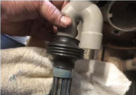
3. Vet de aandrijfjas met vet in en hou de sifon of buis tegen de aandrijfjas en schuif de aandrijfshoes over de aandrijfjas
