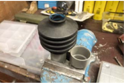
1. Vet de aandrijfshoes aan de binnenzijde in met vet.
