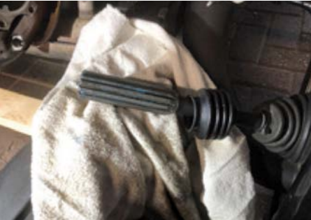
4. Aandrijfshoes over de aandrijfjas geschoven. Vet vervolgens de aandrijving in met voldoende vet en monteer tegengedeelte
