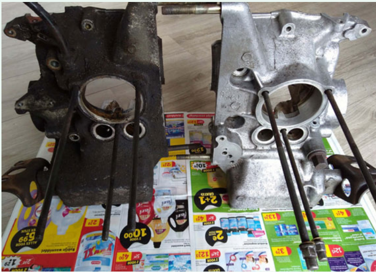
2 motorhelften: de één voorafgaand en de ander na de schoonmaakwerkzaamheden
